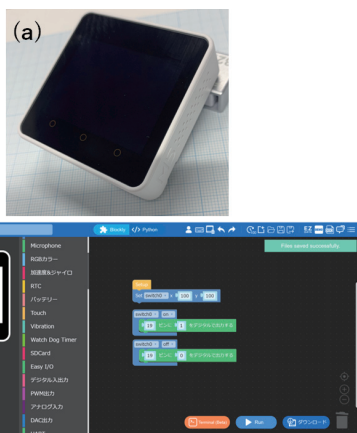
図 3 M5Stack Core2 の外観 (a) と UIFlow によるビジュアルプログラミングの一例 (b)
